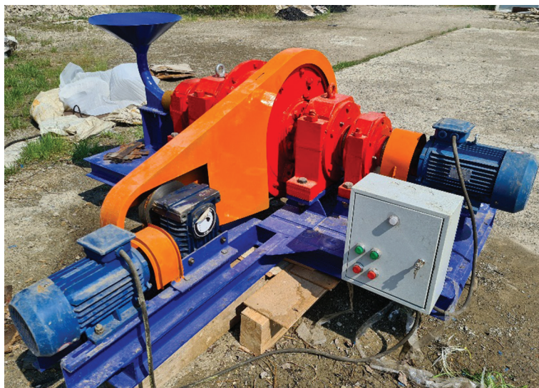
Рис. 3. Опытно-промышленный образец мельницы роторной МДР / Fig. 3. Pilot-industrial sample of the rotary mill MDR
