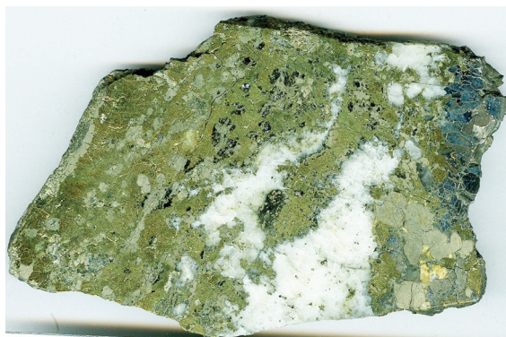
Рис. 5. Арсенопирит-халькопирит-сфалерит-пирит-кварцевый агрегат. Разрез жилы Женевской. 35–43 см от висячего бока. Образец 583А/30 / Fig. 5. Arsenopyrite-chalcopyrite-sphalerite-pyrite-quartz aggregate. Section of the vein of Genevskaya. 35–43 cm from the hanging side. Sample 583A/30
