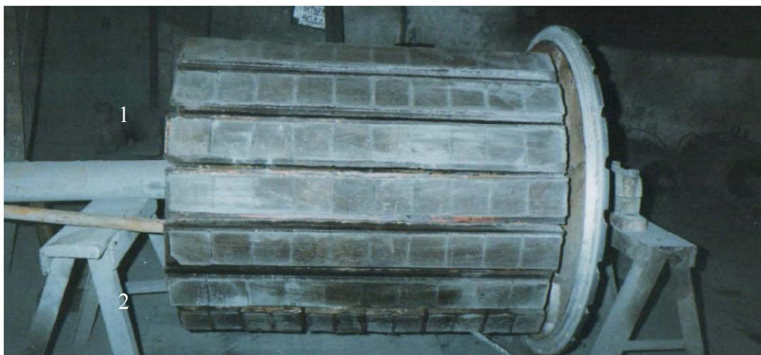
Рис. 2. Общий вид магнитной системы сепаратора ПБС 90/100 с магнитами размером 80x80x20 мм из сплава «неодим-железо-бор» (шесть рядов с чередующейся магнитной полярностью):
