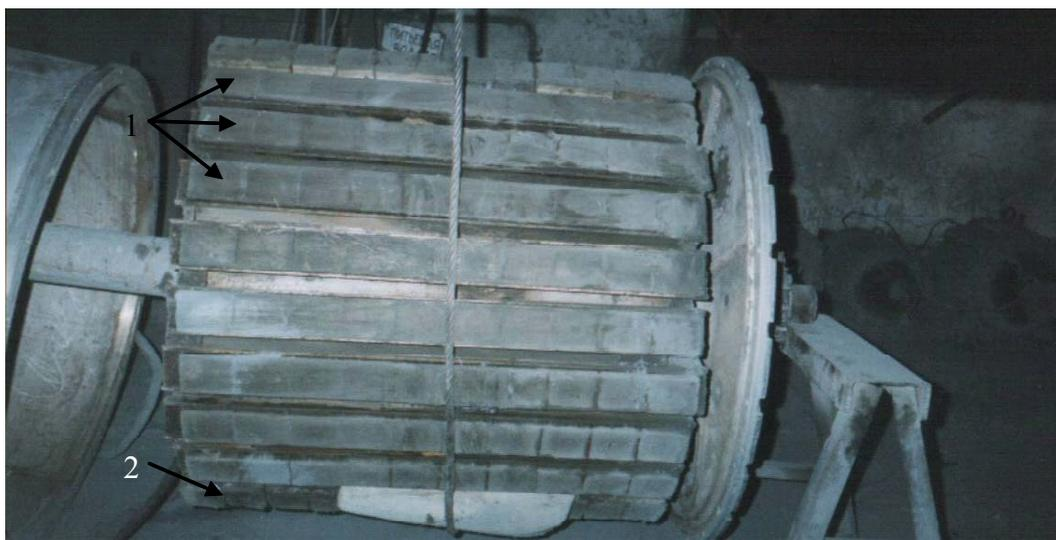
Рис. 3. Общий вид магнитной системы сепаратора ПБС 90/100 с магнитами размером 60x80x20 мм из сплава «неодим–железо–бор» (восемь рядов с чередующейся магнитной полярностью):
