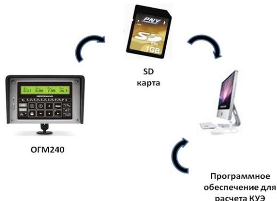
Рис. 2. Перенос информации с бортовой системы ОГМ240 на настольный компьютер для последующей оценки КУЭ
