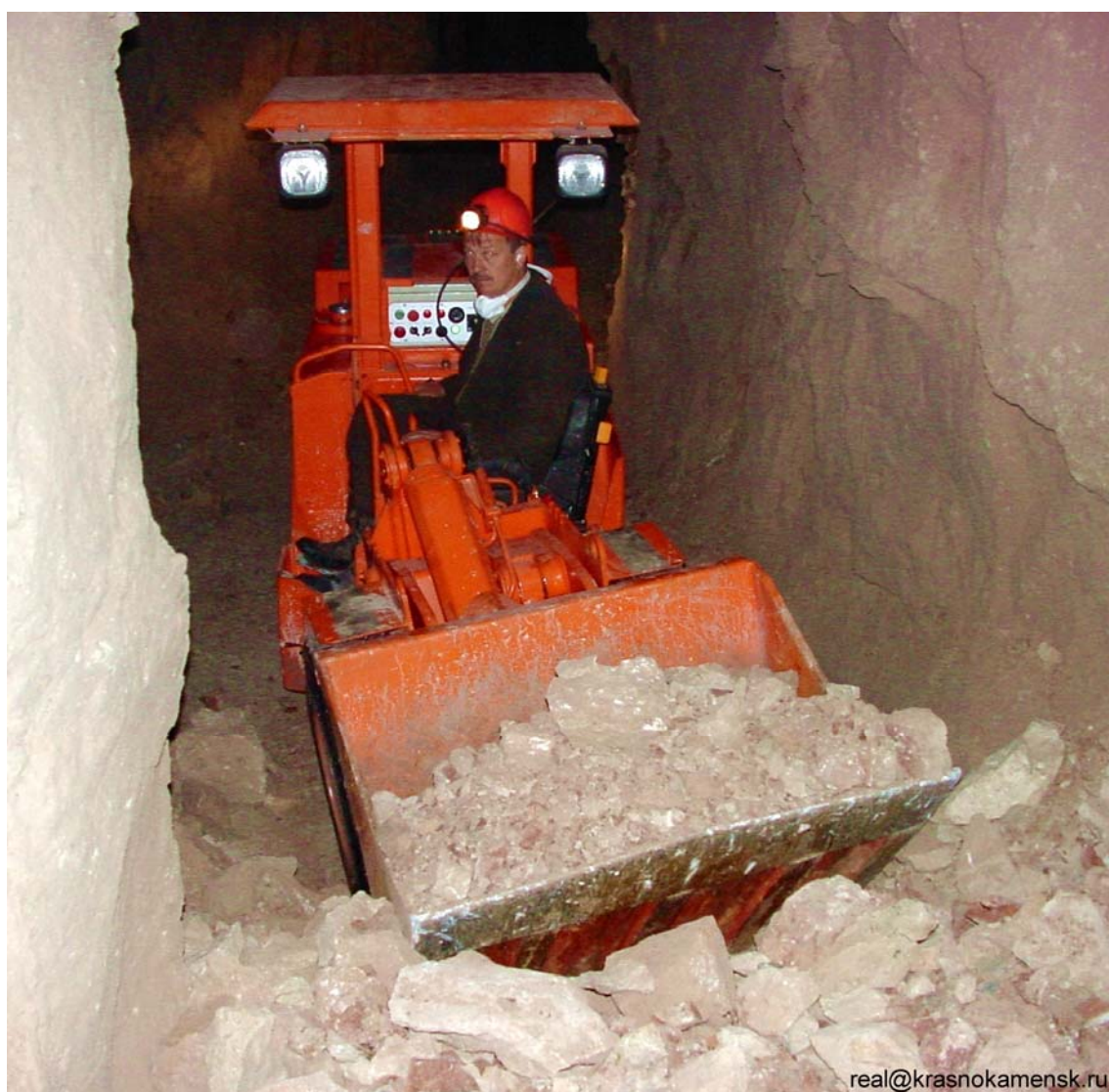
Рис. 1. Отгрузка руды из забоя погрузочно-доставочной машиной «Microscop 100E» в блоке 5-529
