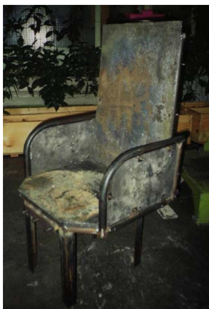
Рис. 4. Общий вид кресла оператора ПДМ, обшитого свинцовым листом
