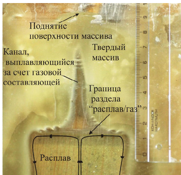
Рис. 3. Структура канала плюма перед прорывом плюма на поверхность при наличии газовой «подушки» над расплавом ( N = 9 Вт, l = 12 мм). Схематично показаны свободно-конвективные течения в расплаве канала плюма / Fig. 3. Plume conduit structure before plume eruption with gas cushion above melt ( N = 9 W, l = 12 mm). Free-convection flows in the melt of the plume conduit are shown schematically
