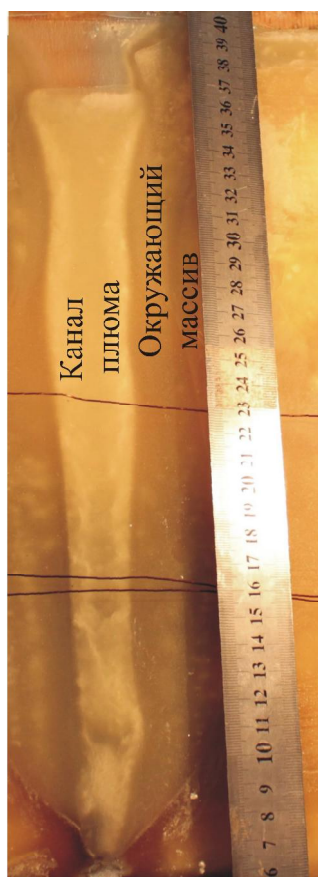
Рис. 2. Канал плюма, выплавленного в наклонном плоском слое над локальным источником тепла, после затвердевания расплава ( N = 5,9 Вт, l = 12 мм) / Fig. 2. Photograph of plume conduit in an inclined flat layer after solidification of melt ( N = 5,9 W, l = 12 mm). The plume conduit was melted above local heat source
