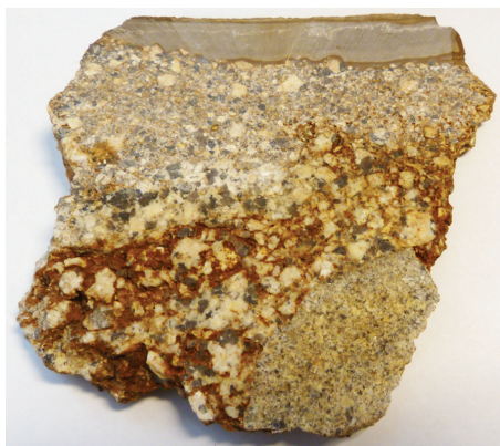
Рис. 4. Дресвяник, содержащий обломок гранита и перекрытый алевролитом. На контакте его с обломком гранита цемент замещён гидроксидами железа / Fig. 4. Psepchite containing a granite fragment and overlapped with siltstone. Cement is replaced by iron hydroxides when it contacts with the granite fragment
