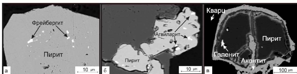
Рис. 3. Включения фрейбергита и агвиларита в пирите (а, б), кайма акантита по пириту (в) / Fig. 3. Inclusions of freibergite and agvilarite in pyrite (a, b), acanthite rim of pyrite (v)
