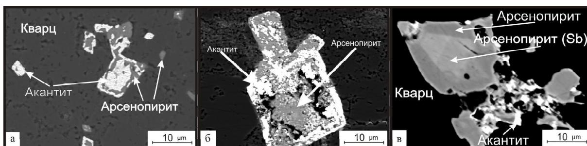
Рис. 2. Взаимоотношение арсенопирита и акантита (а, б), зональный арсенопирит: центральная часть кристалла – сурьмянистый арсенопирит (в) / Fig. 2. The relationship of arsenopyrite and acanthite (a, b), zonal arsenopyrite: central part of the crystal is antimony arsenopyrite (v)
