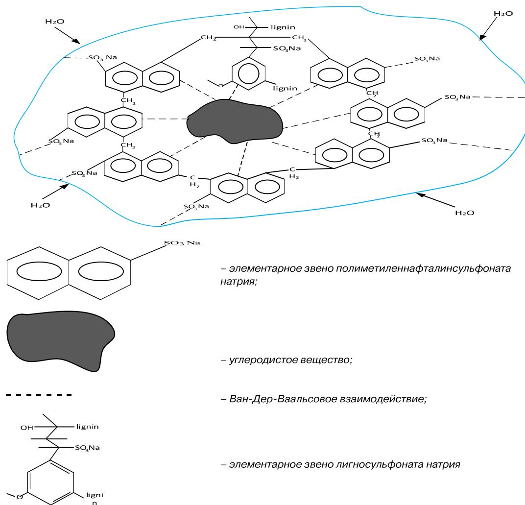
Рис. 4. Механизм образования гидрофильного комплекса «реагент – углеродистое вещество – вода» /
