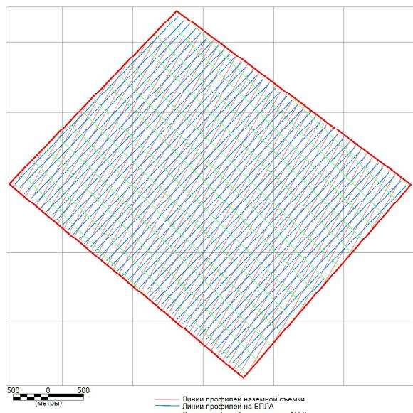
Рис. 4. Карта разведочной сети магниторазведочных работ / Fig. 4. Map of exploration network of magnetic surveys works
