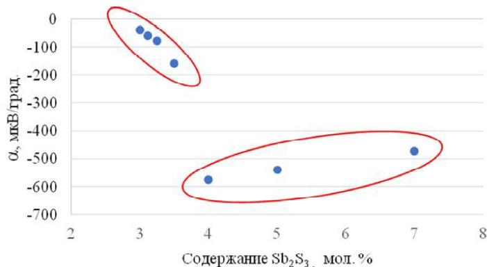
Рис. 1. Корреляционные поля пары «содержание Sb<sub>2</sub>S<sub>3</sub> – коэффициент термоЭДС» в образцах синтезированных галенитов
