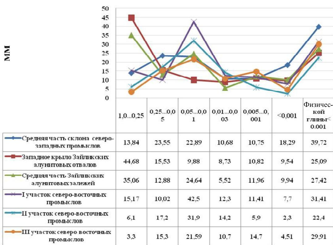
Рис. 2. Гранулометрический состав отвалов пустых пород Дашкесанского горно-обогатительного комбината /
