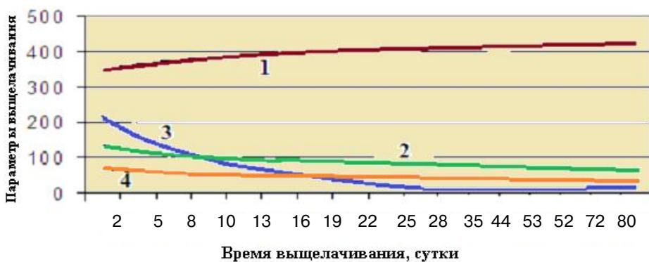
Рис. 1. Зависимость показателей выщелачивания неокисленной руды от времени выщелачивания без окислителя: 1 ряд – OPV, мВ; 2 ряд - Fe (III), мг/л; 3 ряд – Fe (II), мг/л; 4 ряд – концентрация урана, мг/л / Fig. 1. Dependence of the leaching indicators of non-oxidized ore on the time of leaching without an oxidizer:
