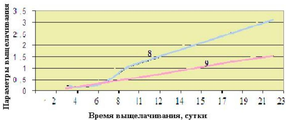
Рис. 5. Зависимость показателей выщелачивания неокисленной руды от времени выщелачивания с перекисью водорода: 8 ряд – Ж/Т; 9 ряд – расход перекиси водорода, кг/т /Fig. 5. Dependence of the leaching indicators of non-oxidized ore on the time of leaching with hydrogen peroxide: Row 8 – W / T; Row 9 – consumption of hydrogen peroxide, kg / t
