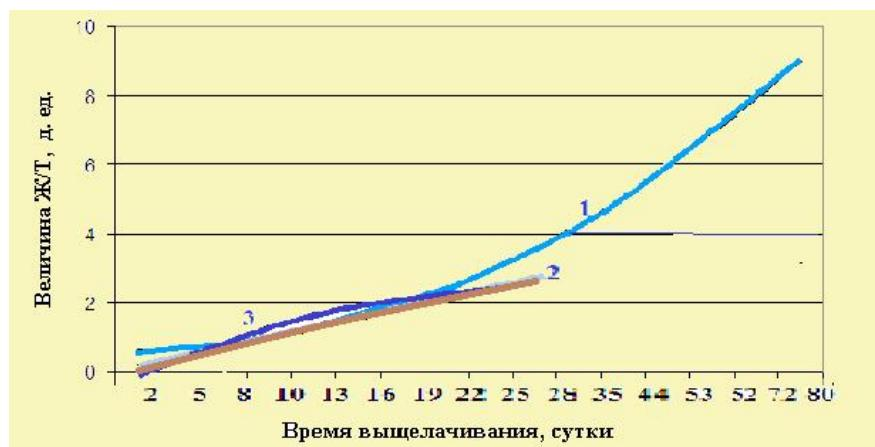
Рис. 9. Зависимость величины Ж/Т от времени выщелачивания неокисленных руд: 1 ряд – без окислителя; 2 ряд – с нитрит натрием; 3 ряд – с перекисью водорода / Fig. 9. Dependence of the W/T value on the leaching time of non-oxidized ores: 1 row – without oxidizer; 2 row – with sodium nitrite; 3 row – with hydrogen peroxide
