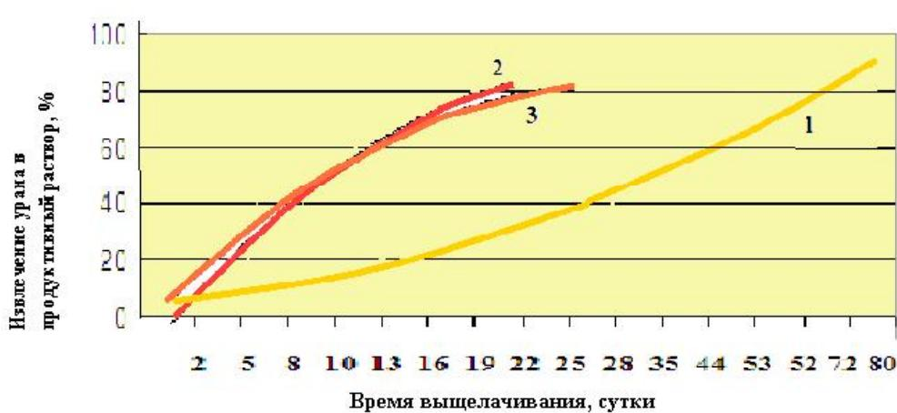
Рис. 12. Зависимость извлечения урана в продуктивный раствор от времени выщелачивания неокисленных руд: 1 ряд – без окислителя; 2 ряд – с перекисью водорода; 3 ряд – с нитрит натрием / Fig. 12. Dependence of uranium extraction into a productive solution on the leaching time of non-oxidized ores: 1 row – without an oxidizer; 2 row – with hydrogen peroxide; 3 row – with sodium nitrite
