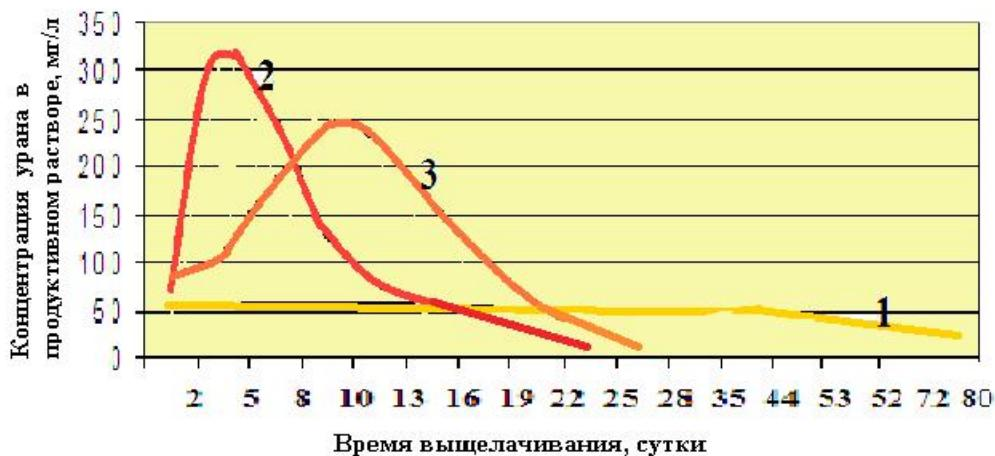
Рис. 11. Зависимость концентрации урана в продуктивном растворе от времени выщелачивания неокисленных руд: 1 ряд – без окислителя; 2 ряд – с перекисью водорода; 3 ряд – с нитрит натрием / Fig. 11. Dependence of the uranium concentration in the productive solution on the leaching time of non-oxidized ores: 1 row – without an oxidizer; 2 row – with hydrogen peroxide; 3 row – with sodium nitrite
