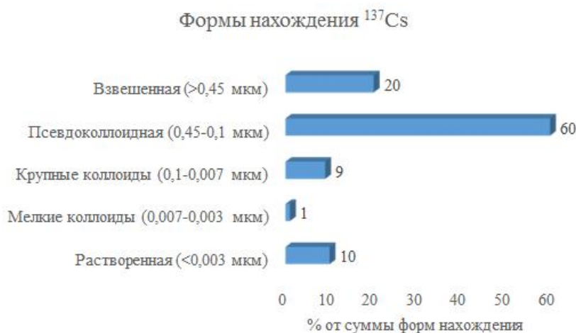
Рис. 2. Формы нахождения ^{137}\text{Cs} в модельных растворах / Fig. 2. Speciation of ^{137}\text{Cs} in water in laboratory scale experiments
