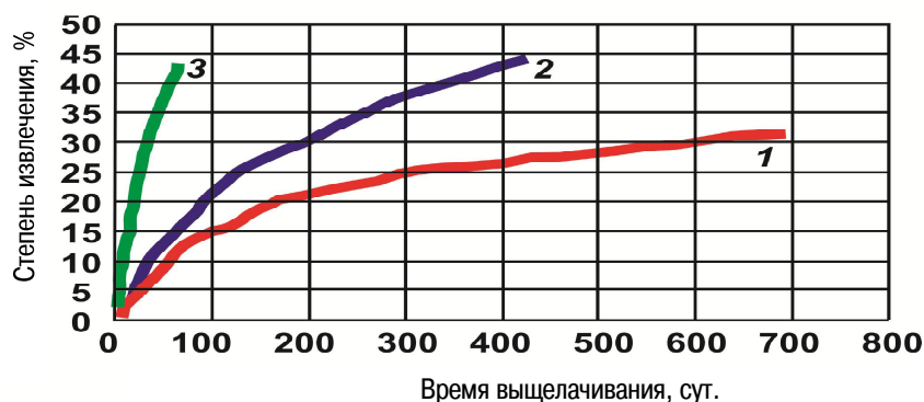
Рис. 2. Зависимость степени извлечения металла по различным камерам блока 4Д-701 от времени / Fig. 2. Dependence of metal extraction degree at various chambers of the block 4D-701 from time to time
