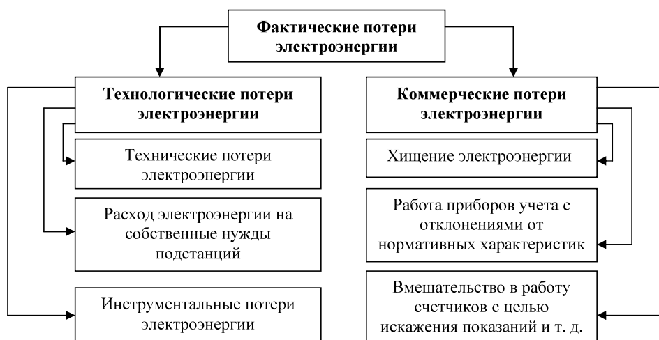
Рис. 3. Структура потерь электроэнергии / Fig. 3. Structure of electricity losses
