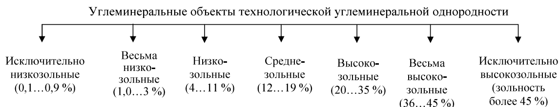
Рис. 9. Категории углеминеральных объектов технологической углеминеральной однородности в аспекте зональности ископаемых углей / Fig. 9. Categories of coal-mineral objects of technological coal-mineral homogeneity in the aspect of zoning of fossil coals
