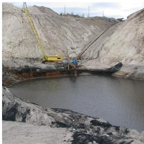
*Рис. 2. Водоотлив на разрезе «Восточный» шахтным насосом*
