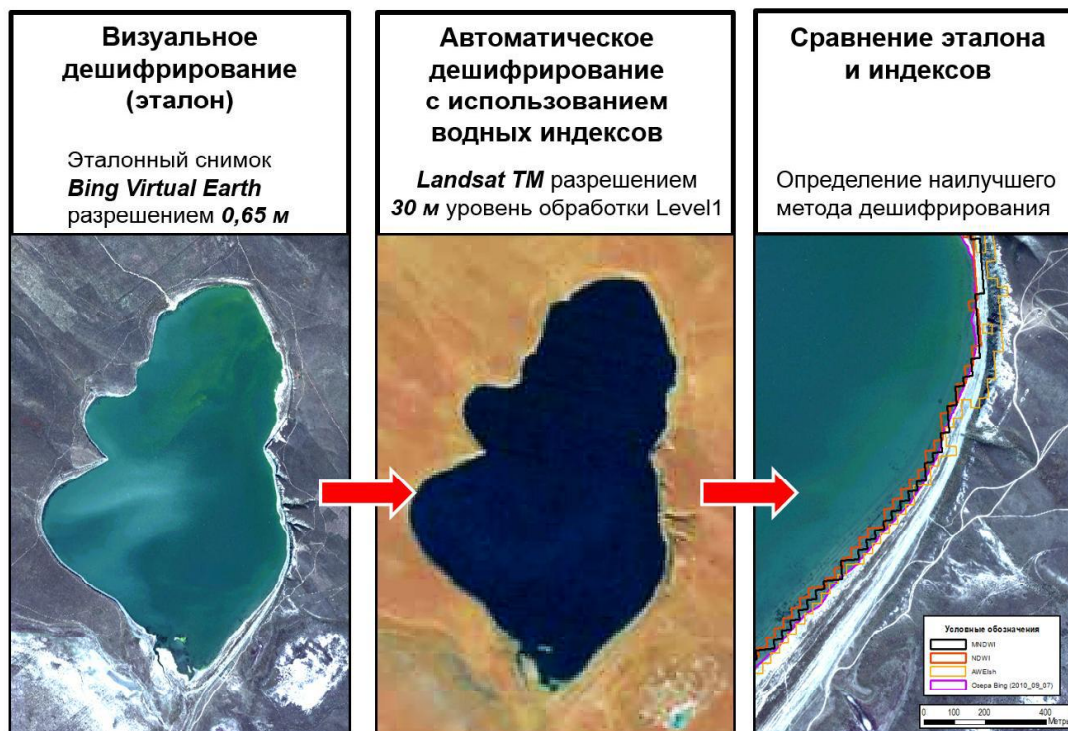
Рис. 3. Сравнение площадей озер, определенных по результатам визуального и автоматического дешифрирования
