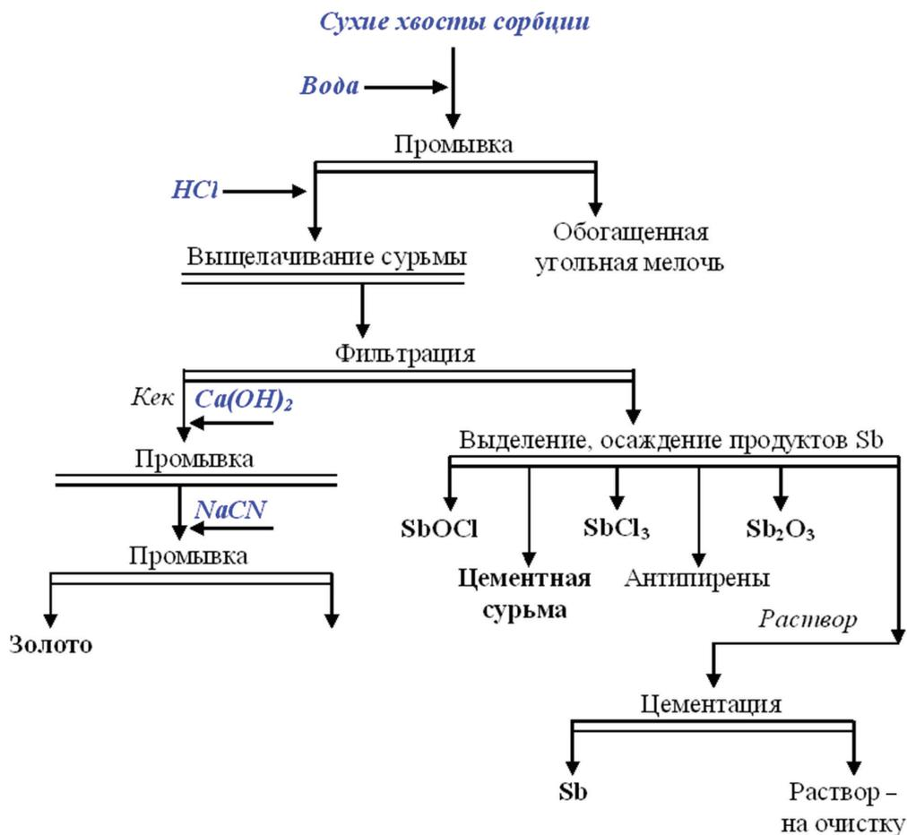
Схема технологии переработки сухих отходов сорбции /
