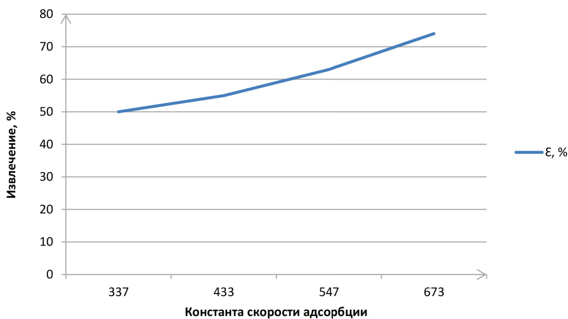
Рис. 3. Зависимости извлечения ценного компонента от константы скорости адсорбции / Fig. 3. Dependences of a valuable component extraction on the rate constant of adsorption
