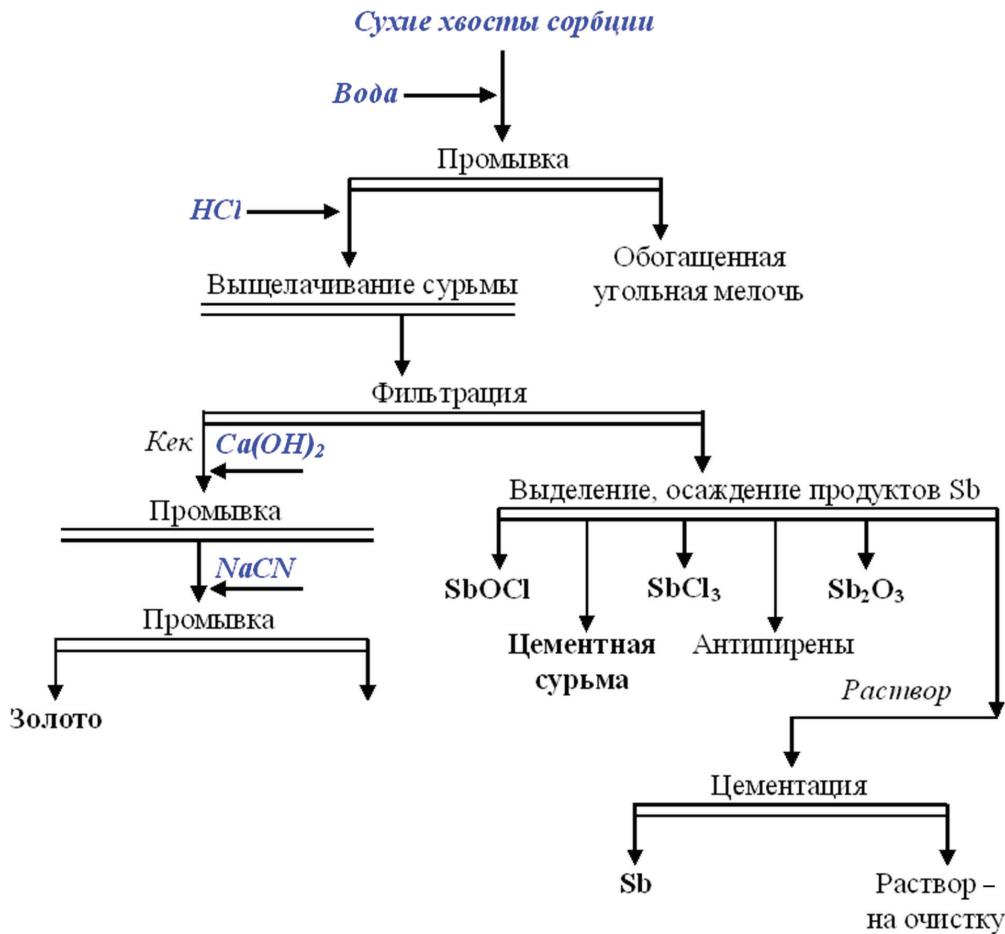
Схема технологии переработки сухих отходов сорбции /
