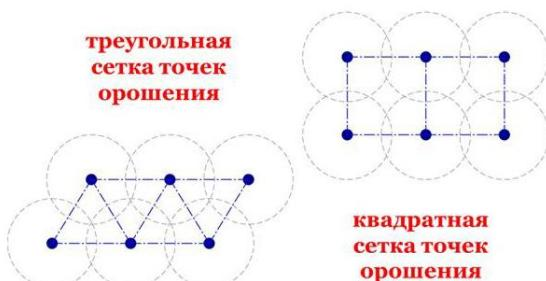
Рис. 7. Сетки расположения оросителей / Fig. 7. The grid arrangement of sprinklers
