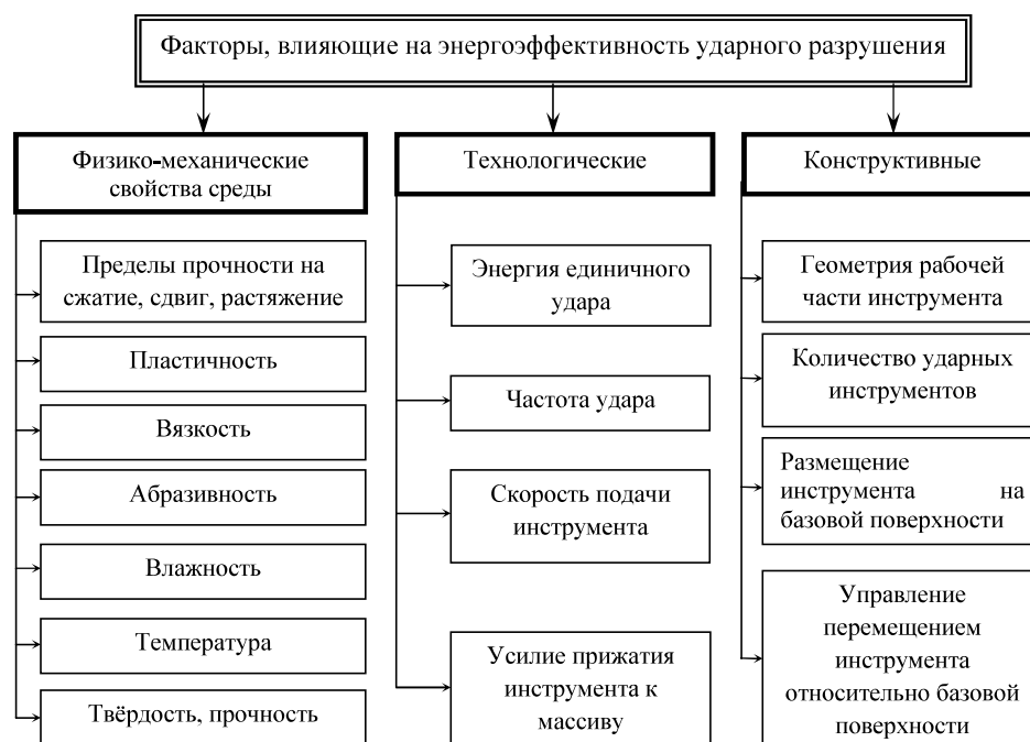
Рис. 1. Факторы, определяющие энергоэффективность ударного разрушения / Fig. 1. Factors determining the energy efficiency of impact failure
