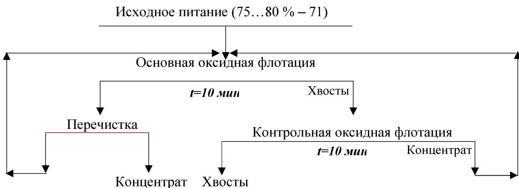
Рис. 8. Схема флотации оксидных форм сурьмы / Figure 8. Scheme of flotation of antimony oxide forms
