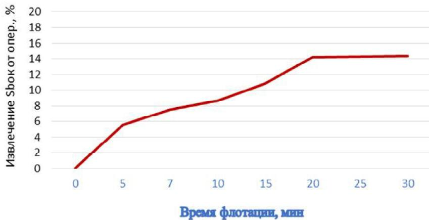
Рис. 7. Кинетика флотационного обогащения оксидной сурьмы с использованием реагента-собирателя  $KC_{Sb}$  / Fig. 7. Kinetics of flotation enrichment of antimony oxide using the KSSb collector reagent
