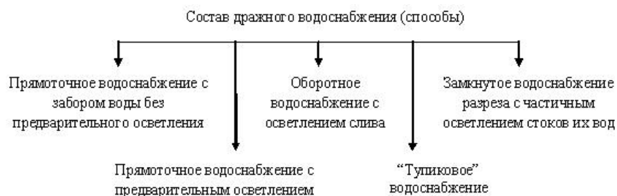
Рис. 9. Исходный состав дренажного водоснабжения (в аспекте его способов)/ Fig. 9. The initial composition of dredging water supply (in terms of its methods)
