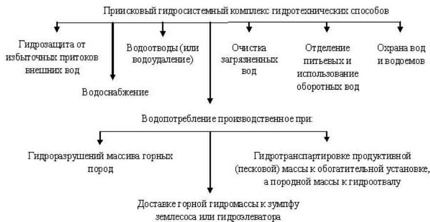
Рис. 7. Общий состав приисковых производственных гидросистемных комплексов при гидротехнических способах открытой разработки россыпей/ Fig. 7. The total composition of gold mining hydro-system complexes in the hydrotechnical methods of open-cast mining
