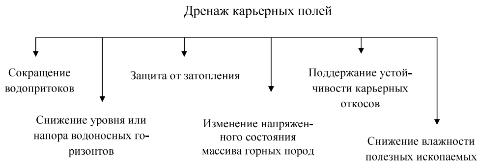
Рис. 5. Типы дренажа карьерных полей (в аспекте его назначений)
