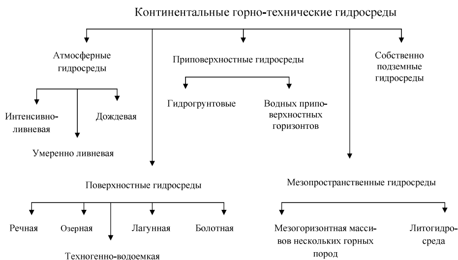
Рис. 12. Общий состав континентальных горнотехнических гидросред в аспекте их пространственного положения
