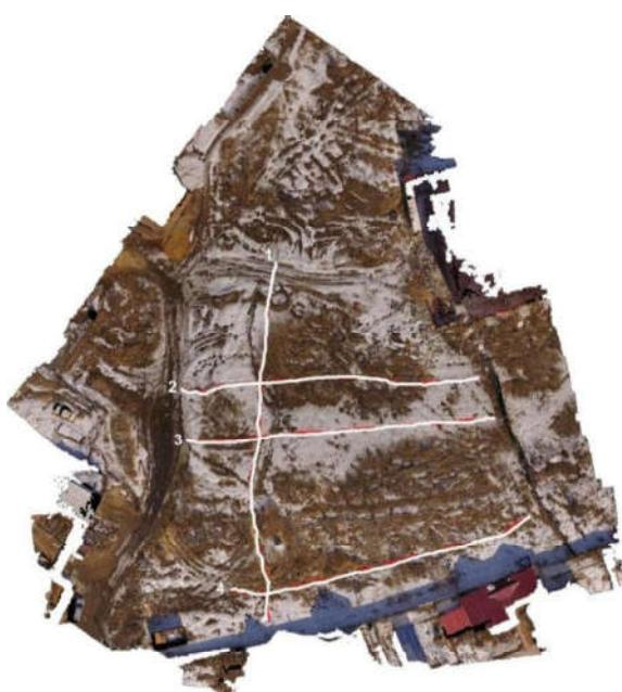
Рис. 2. План криогенного стационара Института мерзлотоведения Сибирского отделения Российской академии наук «Криопег». 1, 2, 3, 4 – направление георадиолокационного профилирования слоя сезонного оттаивания и промерзания пород / Fig. 2. Plan of the cryogenic hospital Permafrost Institute of the Siberian Branch of the Russian Academy of Sciences «Kriopag». 1, 2, 3, 4 – direction of georadialocation profiling of a layer of seasonal thawing and freezing of rocks
